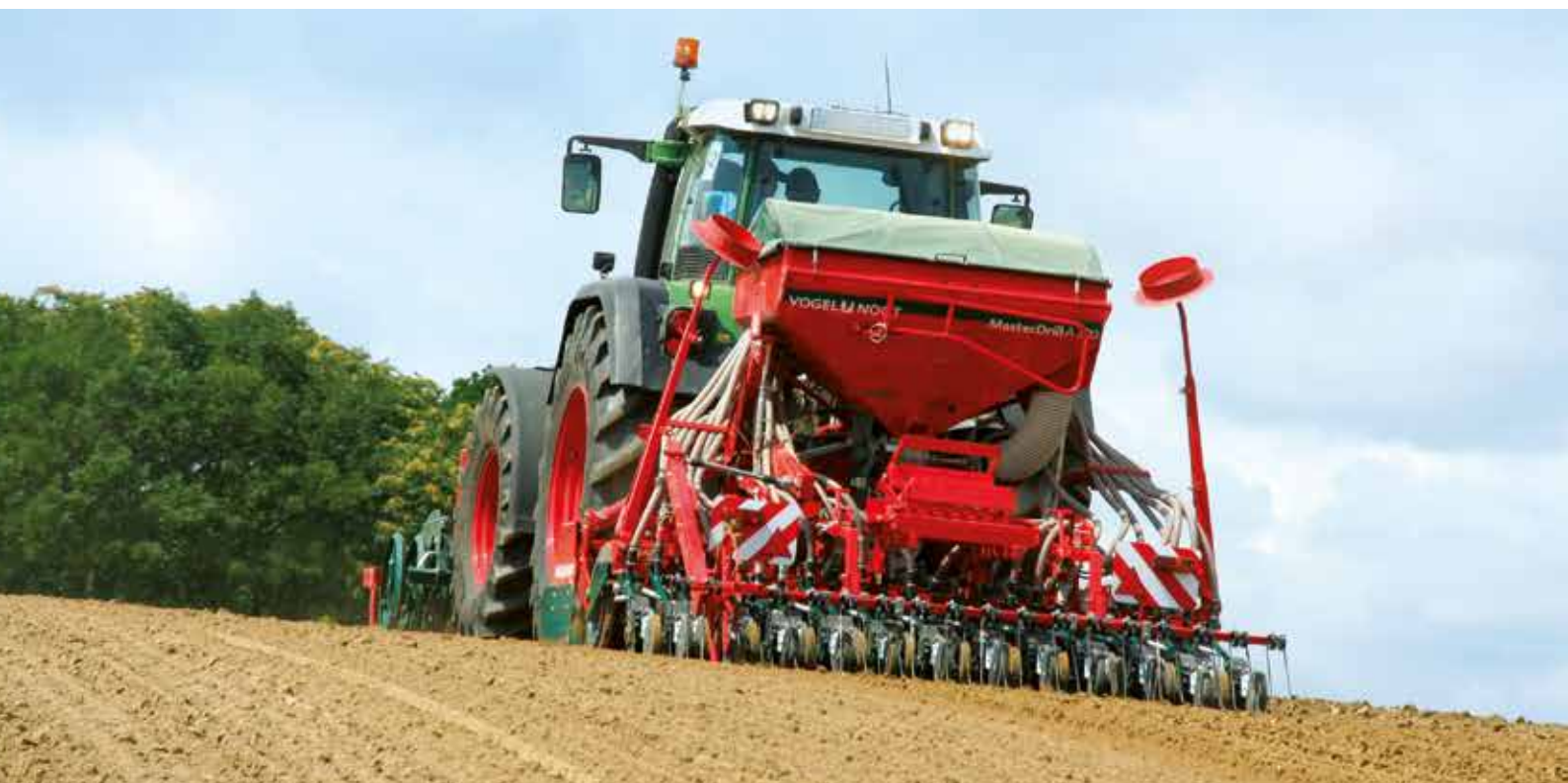
Semoir MasterDrill A300 avec double disques et roues plumbeuses
